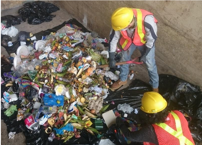
Figura 7. Cuarteo de los desechos sólidos UMB
