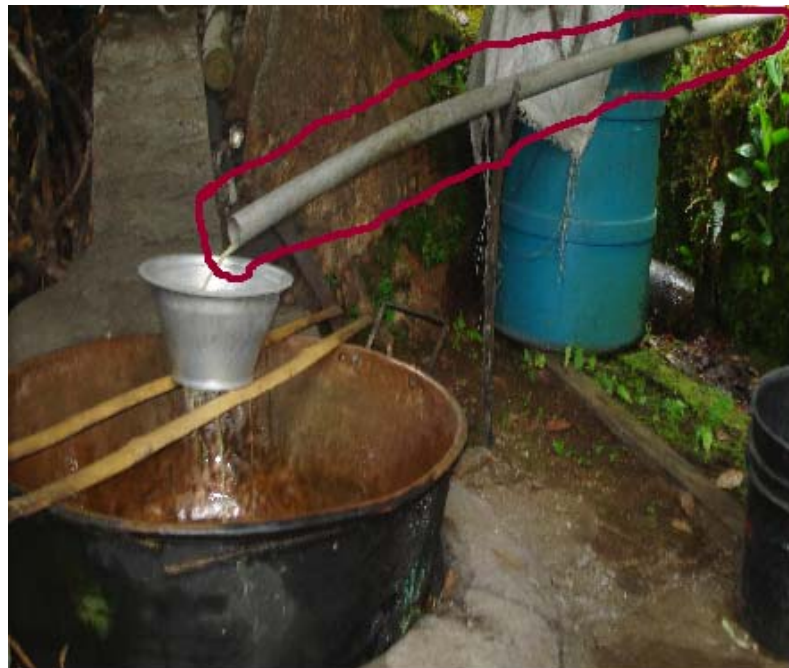
Foto 8: Tubería de Transportación de jugo de caña a la paila
