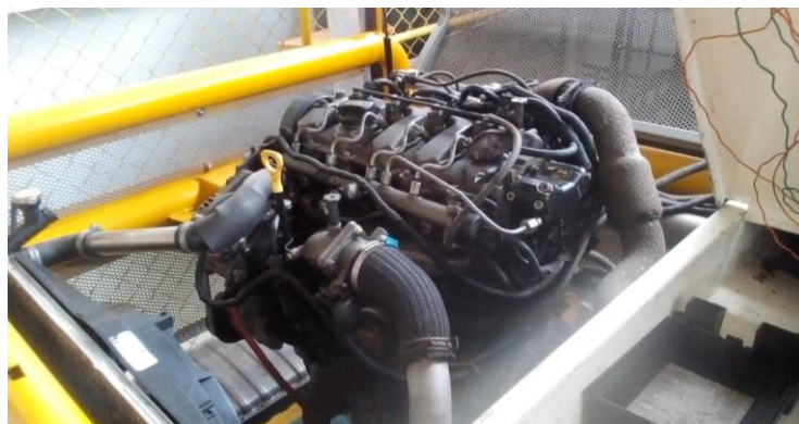
Figura 55. Motor CRDI del banco de pruebas
