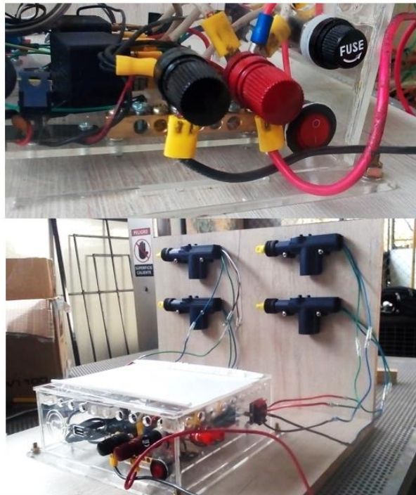
Figura 87. Conexión del sistema a la fuente 12V para las pruebas
