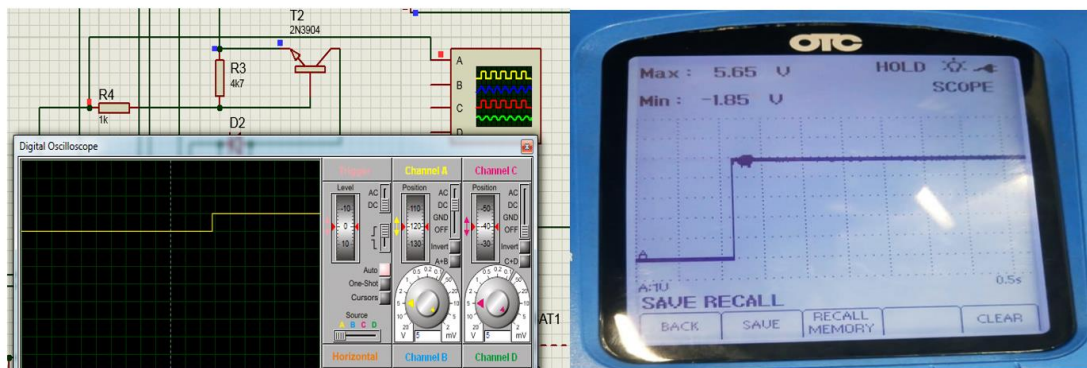
Figura 85. Comparación Simulación-Práctica onda de señal digital pin 13
