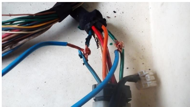
Figura 52. Conexión al switch de encendido en ignición y arranque
