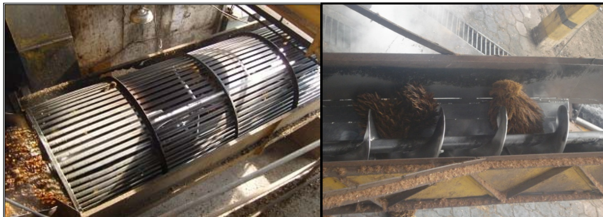
Foto № 8 Tambor rotativo de desprendimiento.
