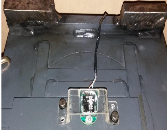
Figura 32. Empernado de los encoders a los platos deslizantes.
