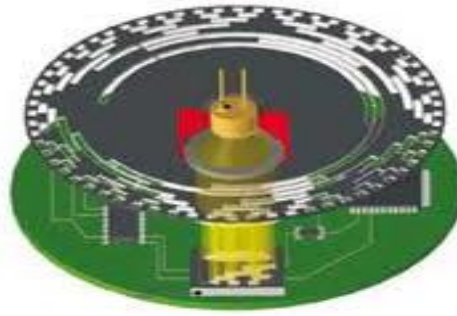
Figura 11. Encoder absoluto y Absoluto multi-vuelta. (Nuria 2017)
