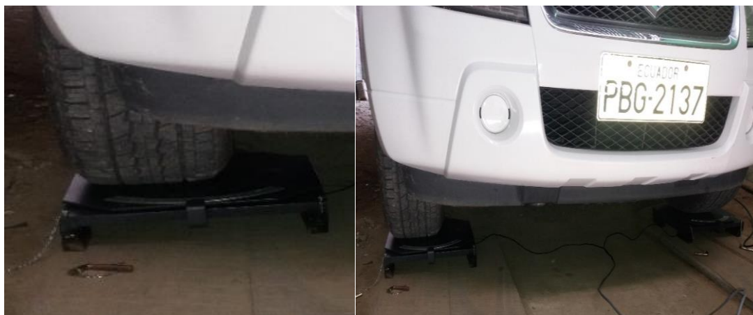
Figura 33. El vehículo sube sobre los platos deslizantes.
