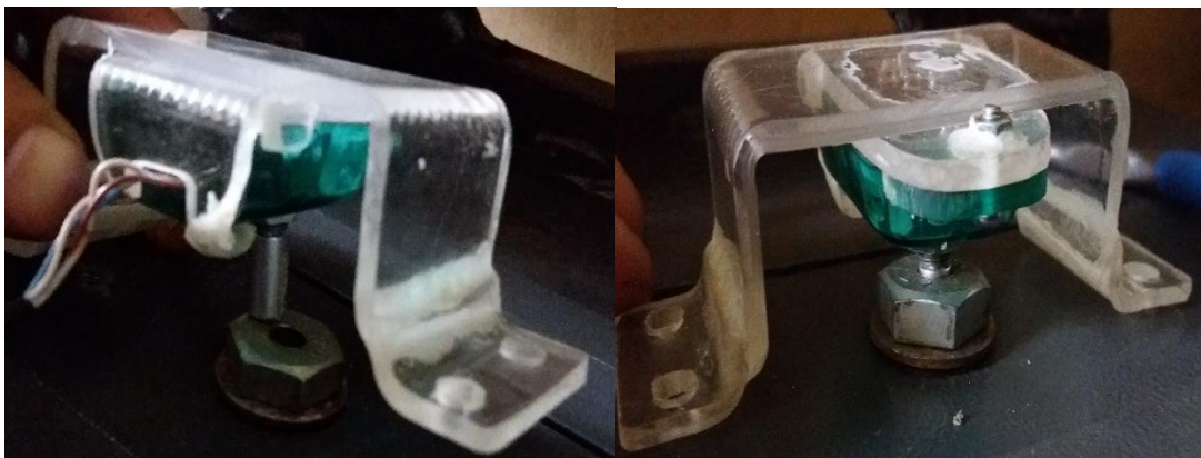
Figura 31. Colocación de encoders incrementales en los platos deslizantes.
