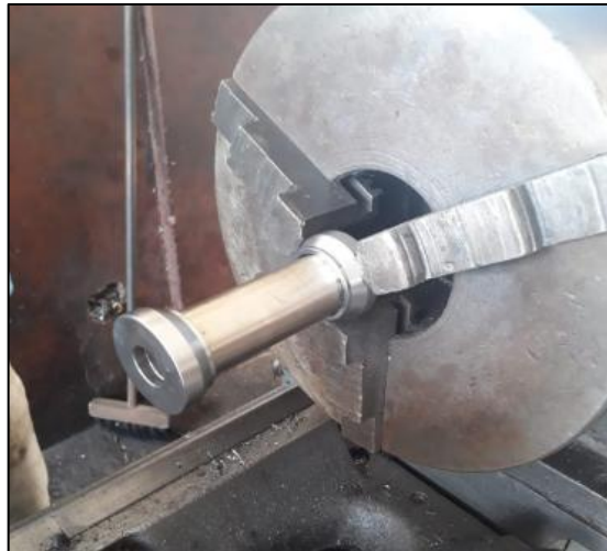
Figura 24. Mecanizado del martillo
