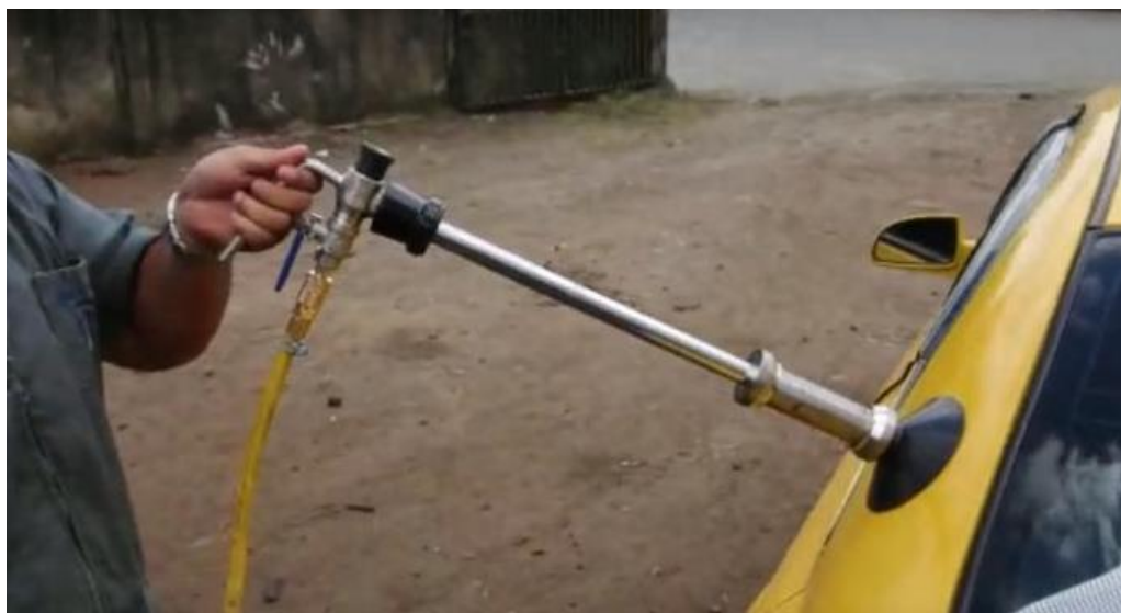
Figura 33. Adherencia de ventosa en carrocería
