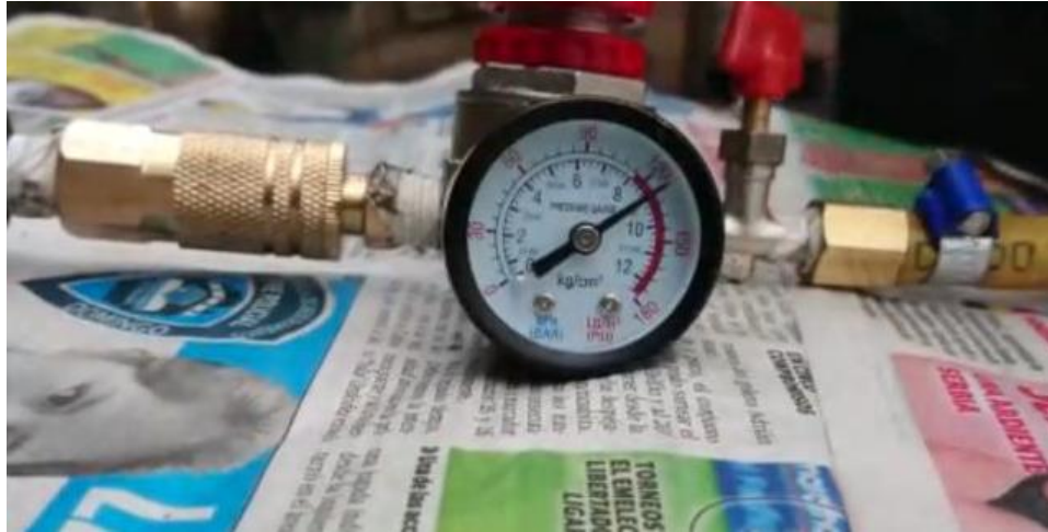
Figura 36. Regulación de presión a 120 psi
