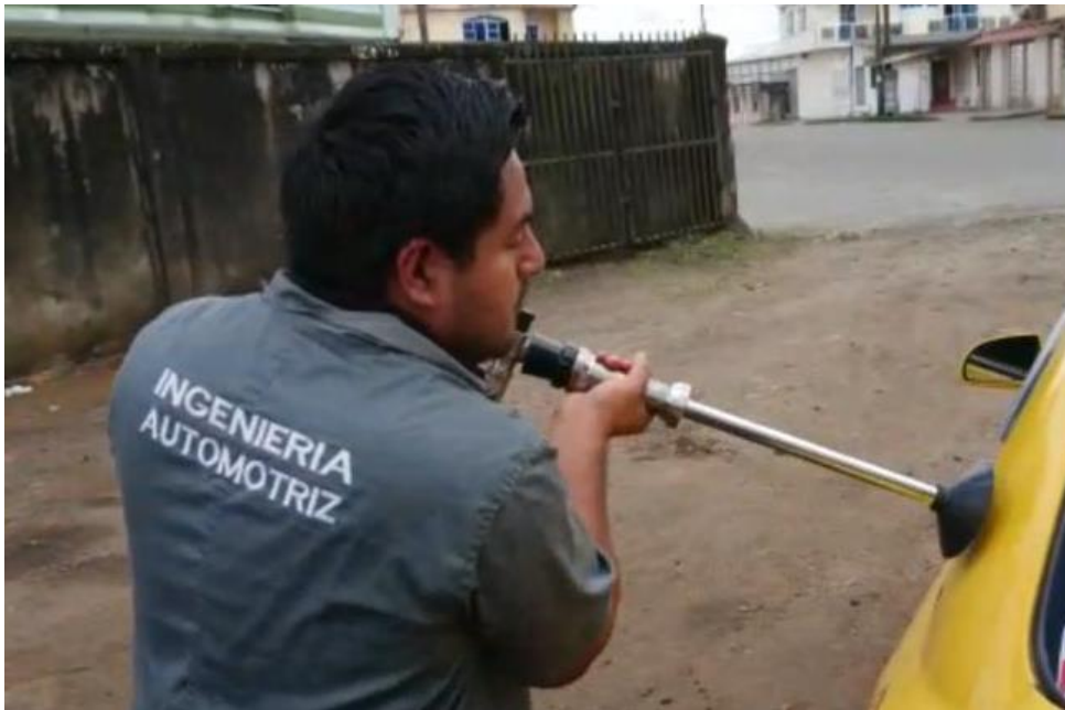
Figura 34. Golpe del martillo deslizante
