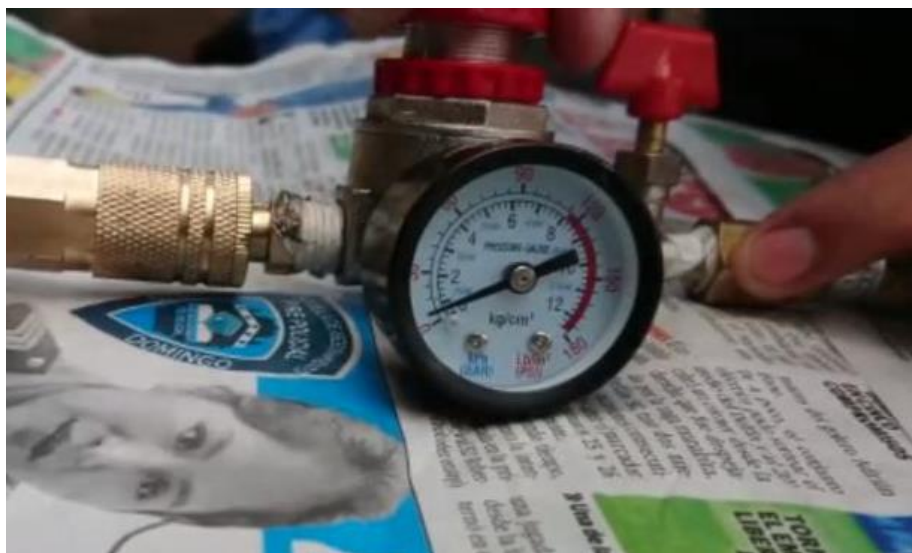
Figura 29. Regulación de presión a 5 psi
