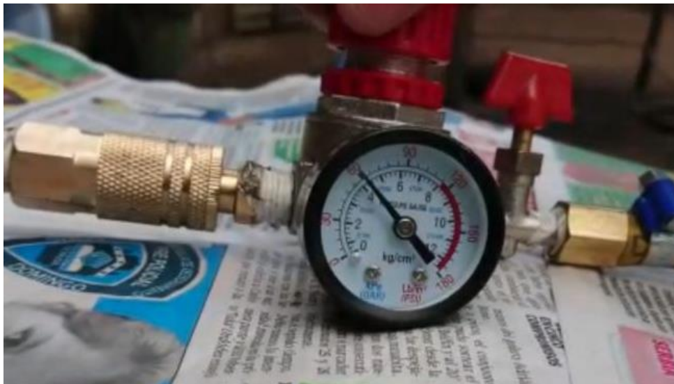
Figura 35. Regulación de presión a 60 psi
