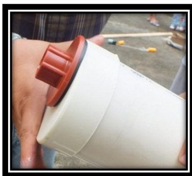
Figura 6 Pegado de los tapones a los tubos PVC de 4”
