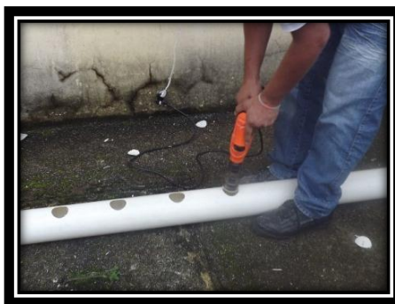
Figura 3 Perforación de los tubos con ayuda de un taladro
