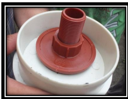
Figura 5 Instalación del adaptador de tanque de ½" a los tapones.
