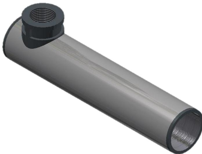
Figura 5. Cilindro del extrusor.
