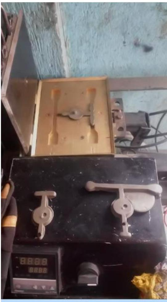
Figura 13. Molde y probeta.
