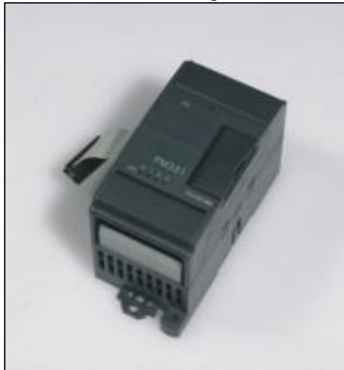
Figura N° 35 Módulo analógico Kinco K331-04RD
