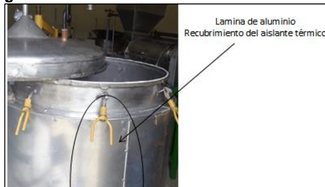
Figura N° 75 Recubrimiento del Aislante Térmico
