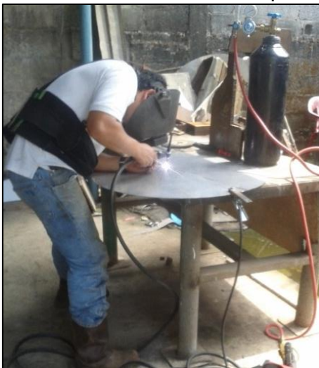
Figura N° 67 Soldadura de la tapa superior
