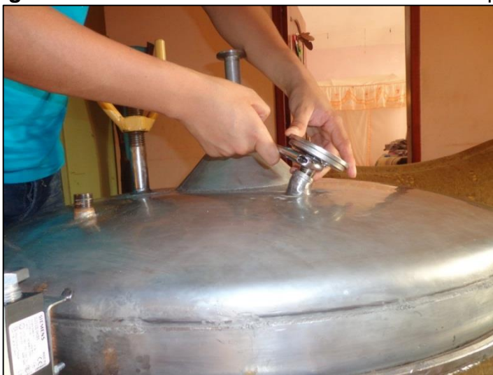
Figura N° 79 Colocación del Termómetro en la tapa
