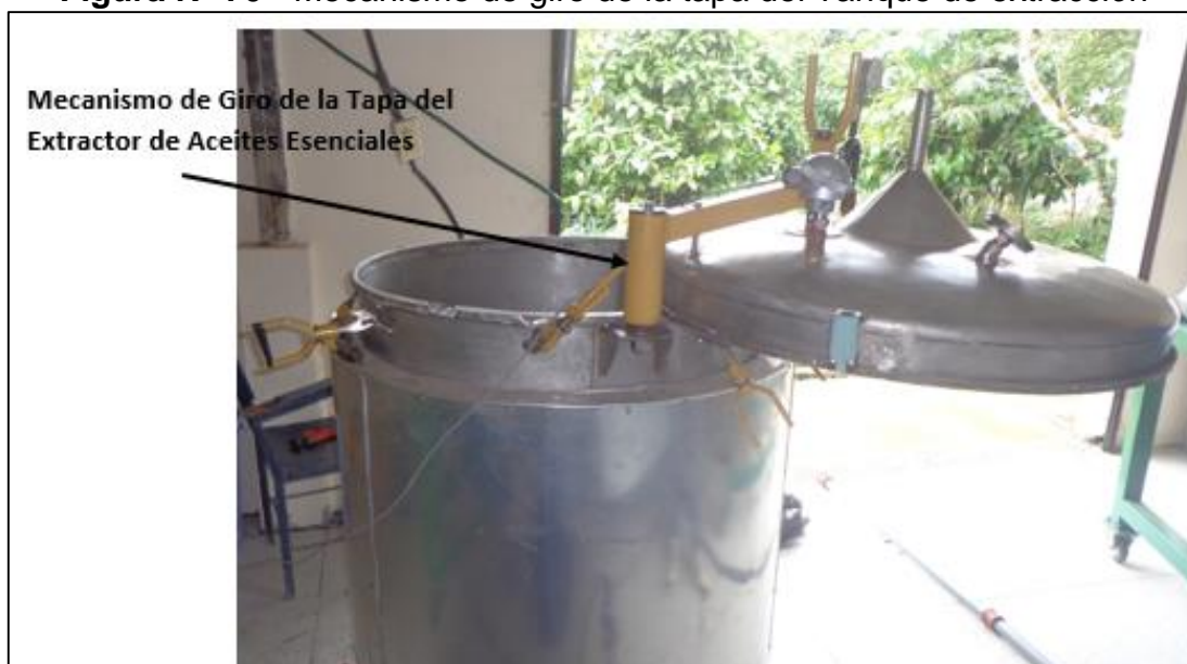
Figura N° 70 Mecanismo de giro de la tapa del Tanque de extracción
