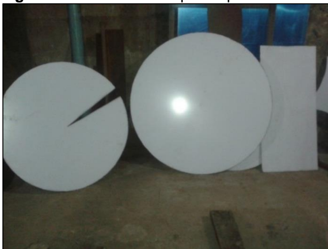
Figura N° 65 Corte de tapas superior e inferior
