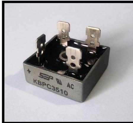
Figura 15: Puentes rectificador KBPC3510
