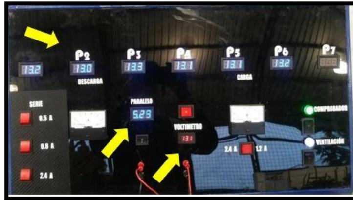
Figura 36: Ubicación de los voltímetros.
