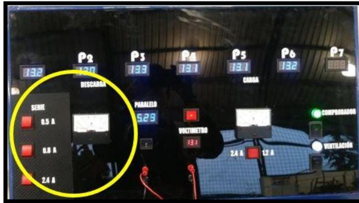
**Figura 32:** Ubicación de los componentes de descarga en serie en el panel de control
