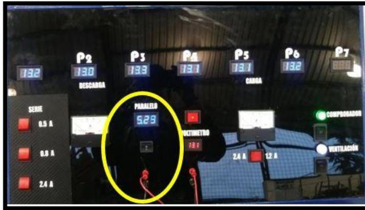
**Figura 34:** Ubicación del circuito de descarga en paralelo
