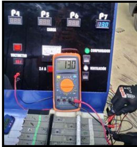
Figura 37: Calibración de voltímetros.
