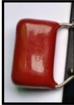
**Figura 17:** Condensador de poliéster
