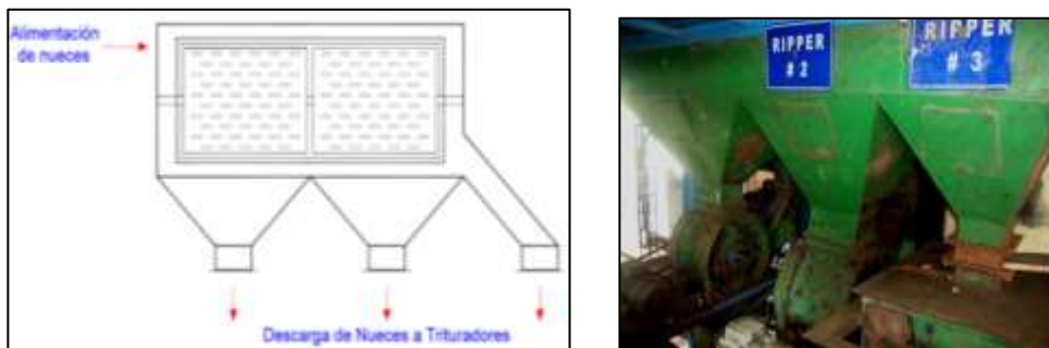
Gráfico N° 3.15 Esquema de un separador neumático
