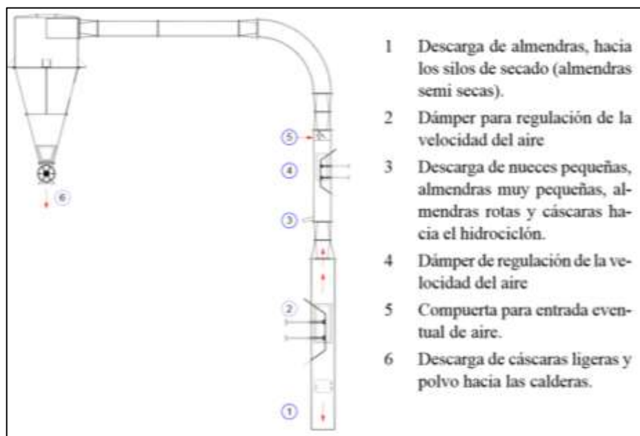
Gráfico N° 3.17 Esquema de un separador neumático
