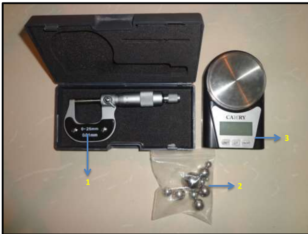
Figura N° 3.4 Densidad de sólidos a través de las dimensiones del cuerpo.
