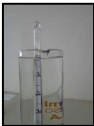
Figura N° 3.8 Medida de densidad de agua utilizando densímetro.
