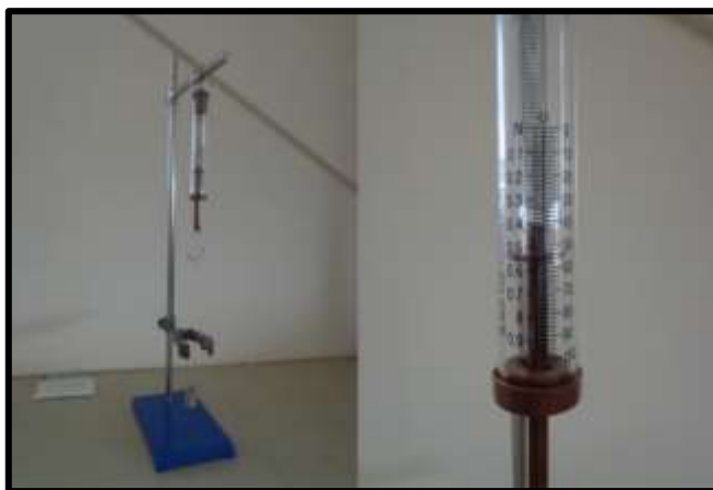
Figura N° 3.10 Valor de fuerza F_1 utilizando el dinamómetro.
