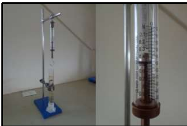
Figura N° 3.12 Valor de fuerza 2 utilizando el dinamómetro.
