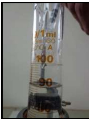
Figura N° 3.13 Completar volumen de agua con jeringa.
