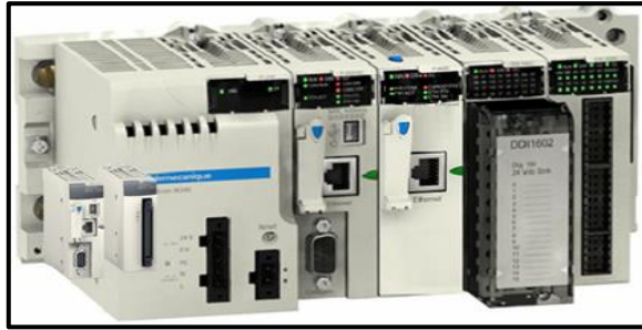
Figura N° 6. 45. PLC Modular Telemecanique
