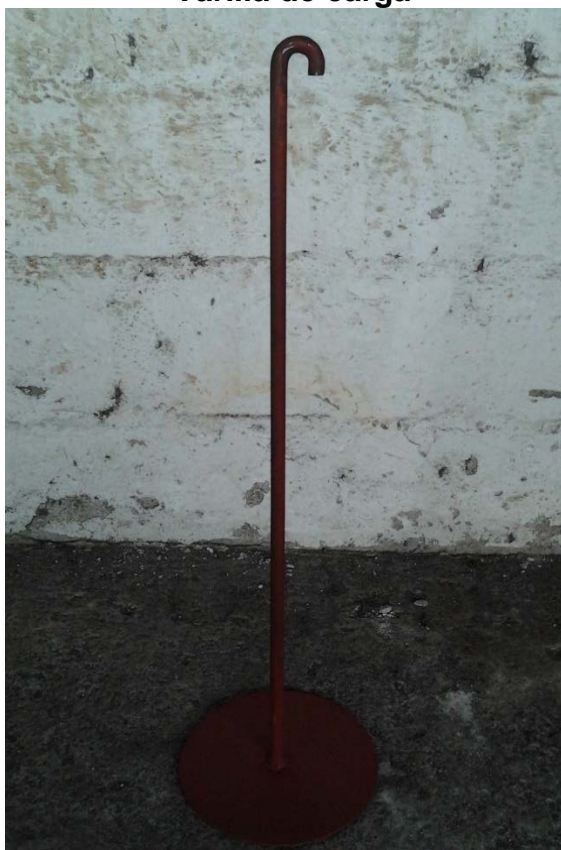
Figura 4.5 Varilla de carga
