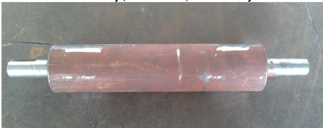
Figura 4.6 Sistema de eje, rodamientos, retenedores y bocín
