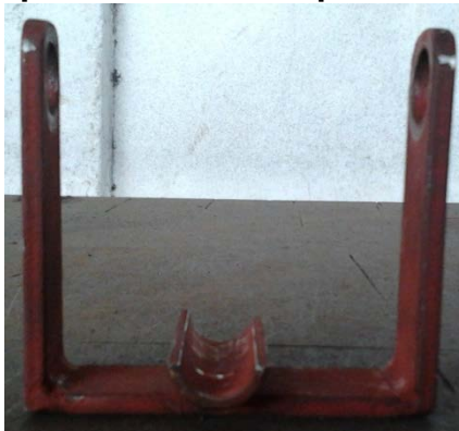
Figura 4.3 Soporte de la varilla portacarga
