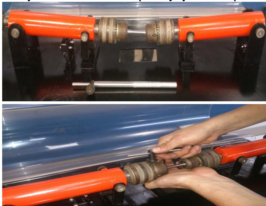
Figura 5.2 Montaje del mandril de contrapunto y ajuste de la probeta
