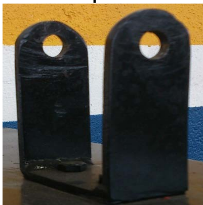
Figura 4.2 Elementos de soporte de los bocines
