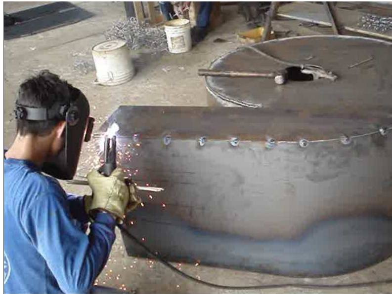
Figura 4-9 Soldadura de la base y las paredes de la Voluta
