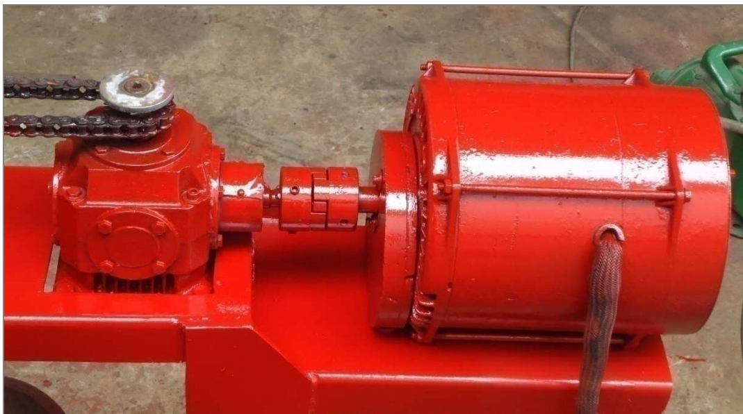
Figura 4-19 Montaje del acople
