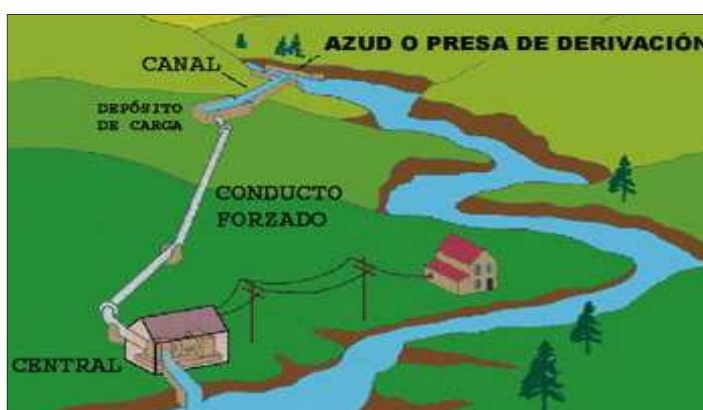
Figura 2-5 Elementos de la Construcción de una Central
