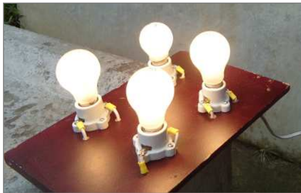
Figura 5-1 Conexión de cargas resistivas
