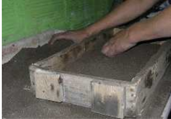
Figura 4-13 Preparación del molde para la fundición de los álabes
