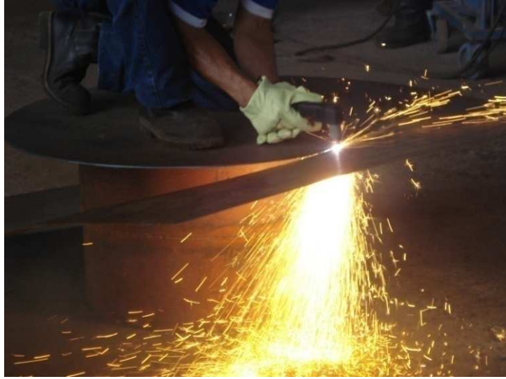
Figura 4-7 Corte de la base de Voluta
