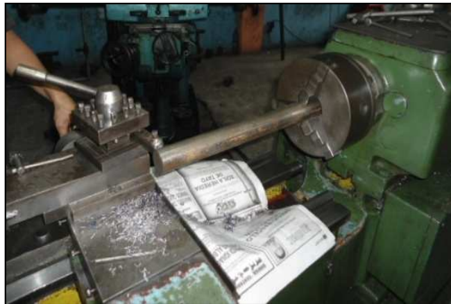
Figura 4-15 Construcción del eje
