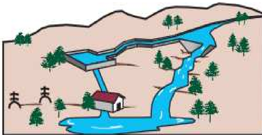
Figura 2-9 Central Hidroeléctrica de Tipo Fluyente
