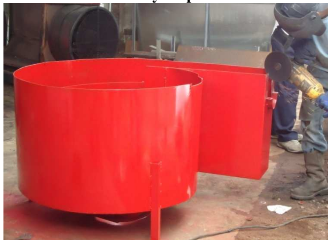
Figura 4-11 Soldadura de la base y las paredes de la Voluta
