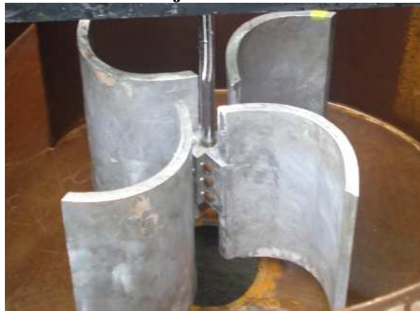
Figura 4-14 Montaje de los álabes
