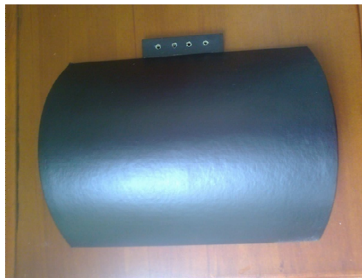
Figura 4-12 Modelo de álabe de madera
