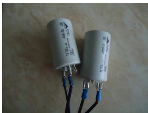
Figura 5-3 Conexión de carga capacitiva
