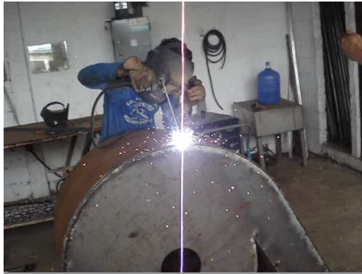
Figura 4-10 Soldadura de la base y las paredes de la Voluta
