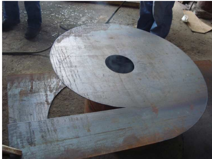
Figura 4-8 Corte completo de la base de Voluta
