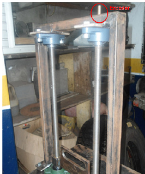
IMAGEN 4.39 EJE SOBRESALIDO PARA MONTAJE ENCODER
