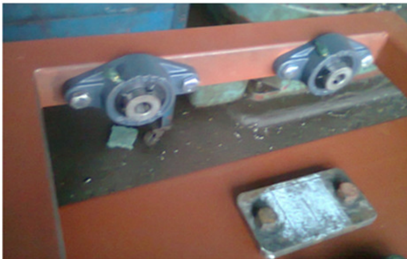
IMAGEN 4.37 MONTAJE CHUMACERAS ESTRUCTURA 2
