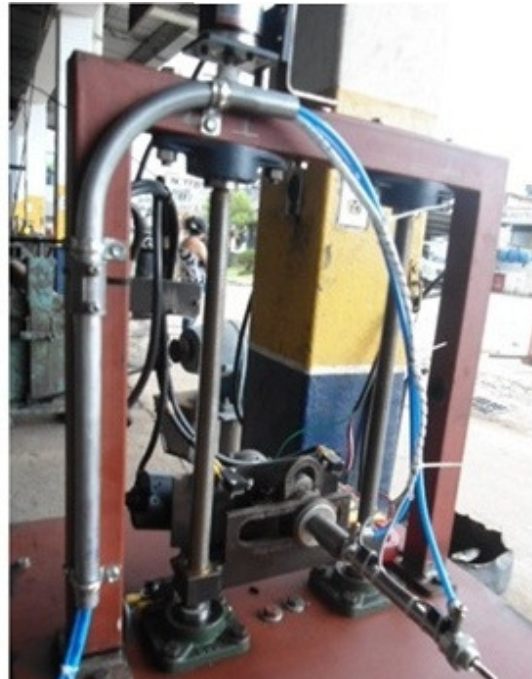
IMAGEN 4.65 MONTAJE TOTAL SISTEMA NEUMÁTICO
