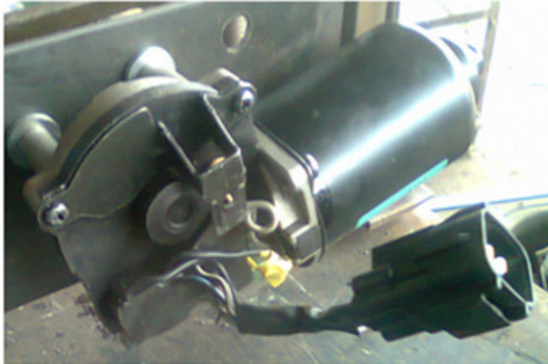
IMAGEN 4.42 MONTAJE DE MOTOR 12 V
