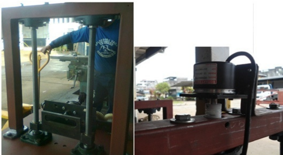
IMAGEN 4.73 MONTAJE MOTORES DE ELEVACIÓN
