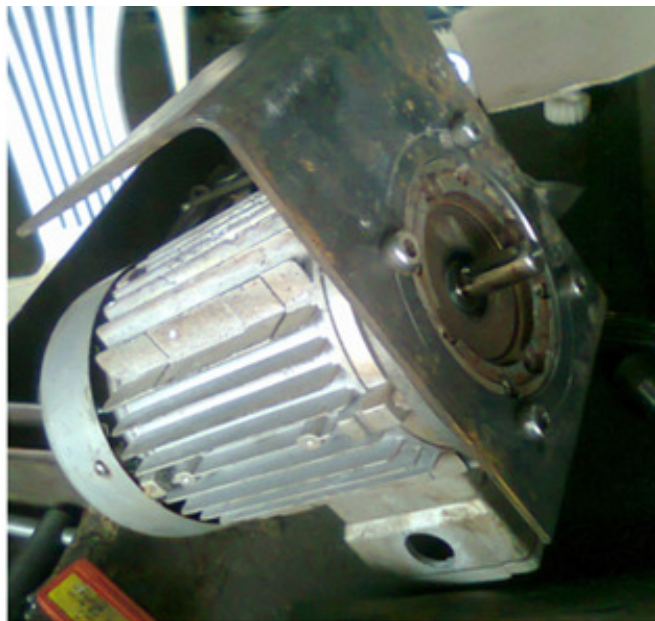
IMAGEN 4.46 FIJACIÓN DE MOTOR EN BASE
