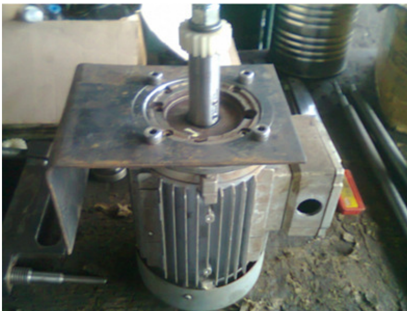
IMAGEN 4.45 COLOCACIÓN DE EJE ALARGADOR EN MOTOR TRIFÁSICO
