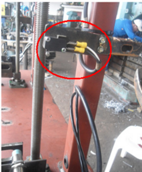
IMAGEN 4.59 MONTAJE FINALES DE CARRERA LADO SUPERIOR
