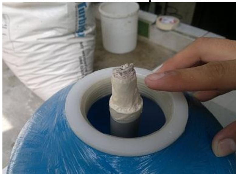
Figura 4.10 Obstrucción de la entrada superior del ducto
