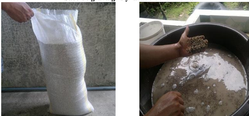
Figura 4.11 Saco de grava gris y lavado de la misma
