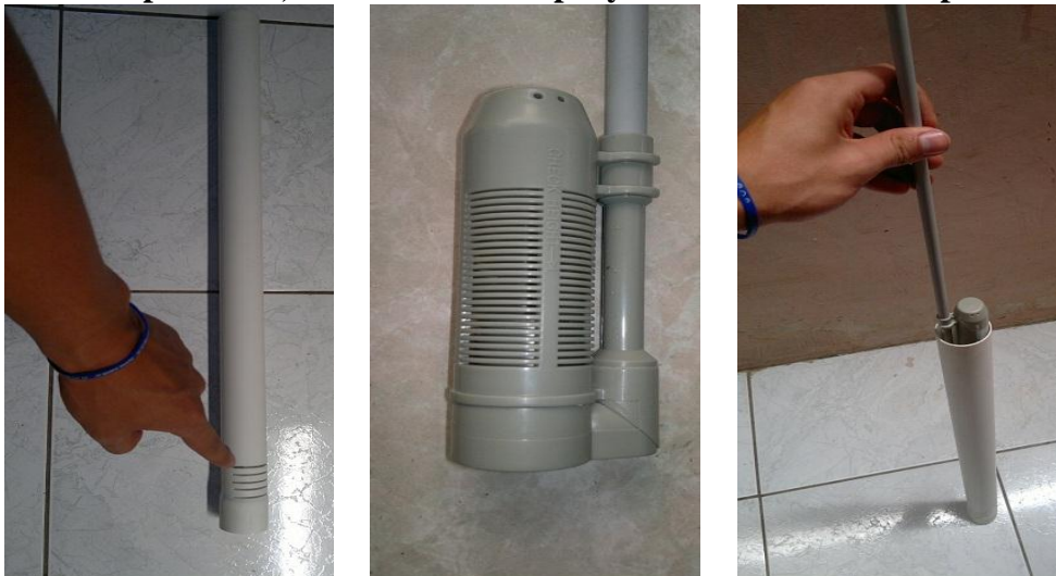
Figura 4.23 Tubo protector, válvula check de pie y ducto de succión completo
