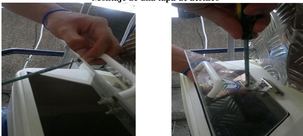
Figura 4.20 Montaje de una tapa de acrílico
