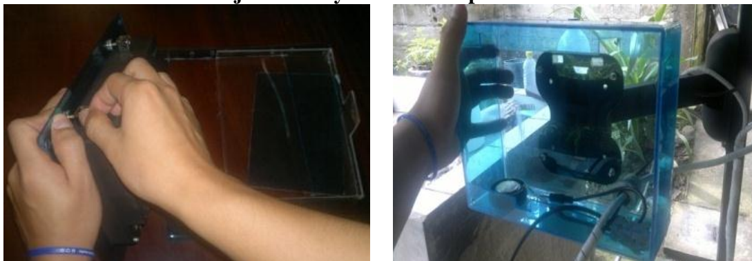
Figura 4.40 Caja acrílica y brazo móvil para el HMI
