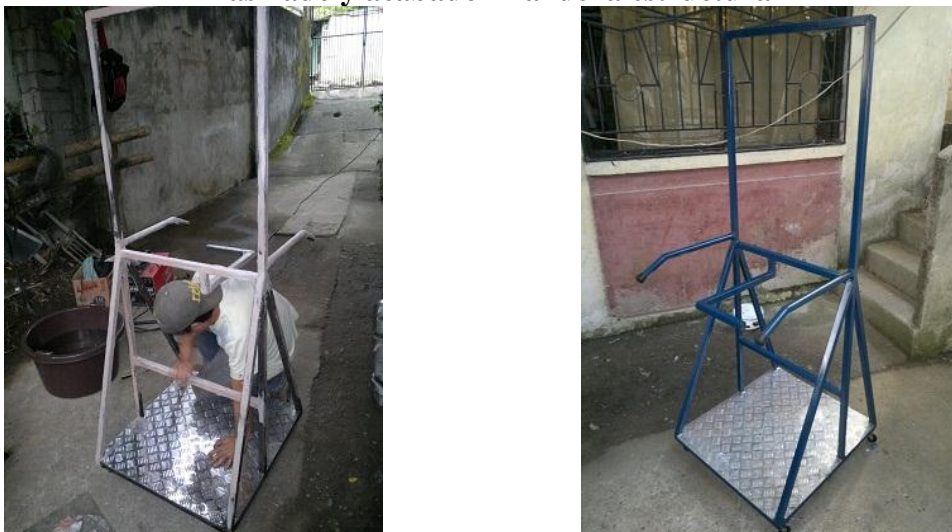
Figura 4.6 Masillado y acabado final de la estructura
