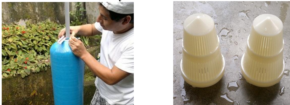
Figura 4.8 Medición de ductos y distribuidores o difusores inferiores
