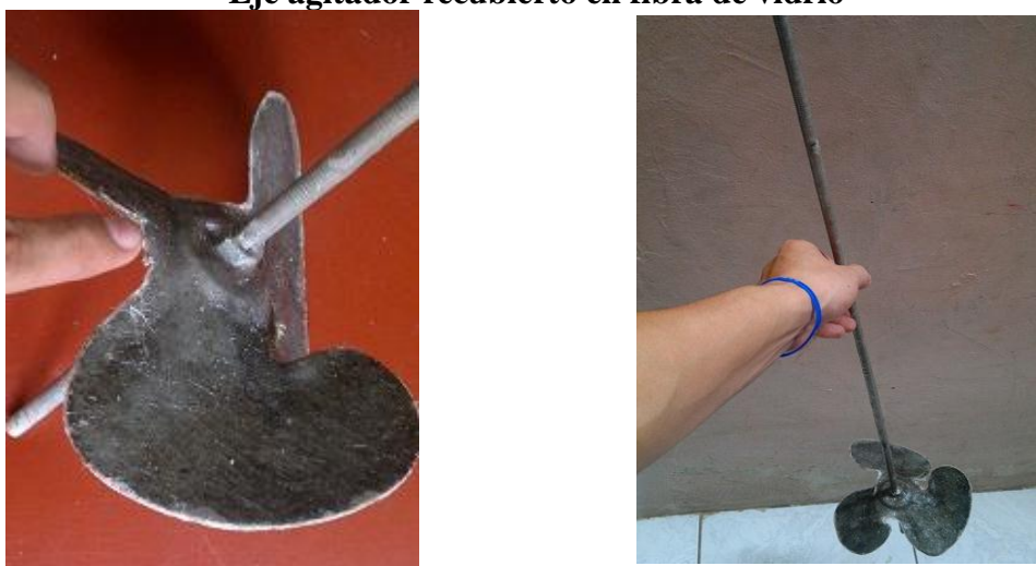
Figura 4.22 Eje agitador recubierto en fibra de vidrio
