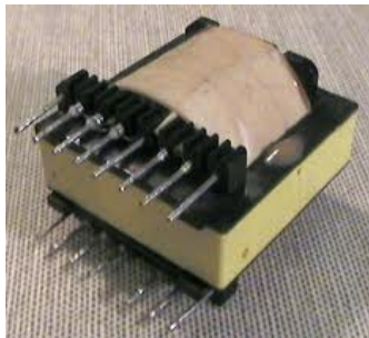
FIGURA 2-4 TRANSFORMADOR DE ALIMENTACIÓN
