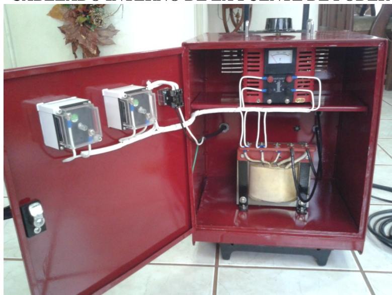
FIGURA 5-13 CABLEADO INTERNO DE LA FUENTE DE PODER
