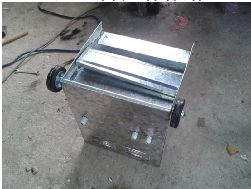
FIGURA 5-7 GABINETE CON PERFORACIONES PARA VENTILACIÓN Y ACCESORIOS
