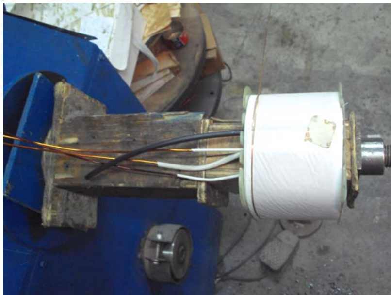
FIGURA 5-3 CONSTRUCCIÓN DE LAS BOBINAS DE B.T. Y A.T.
