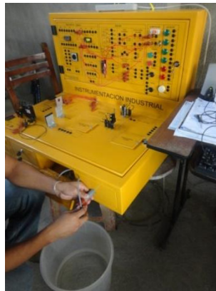
Figura 4.104 Instalación del sensor ultrasónico
