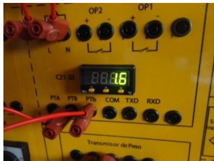
Figura 4.112 Lectura del Peso en el indicador C-21
