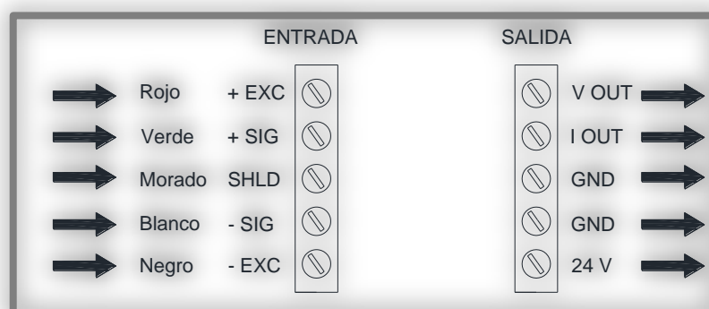
Figura 4.73 Esquema de conexión de la celda de carga al transmisor de peso.
