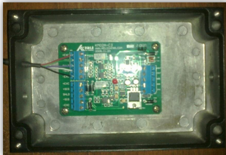
Figura 4.72 Transmisor de peso para celdas de carga.
