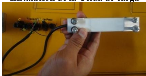
Figura 4.110 Instalación de la Celda de carga
