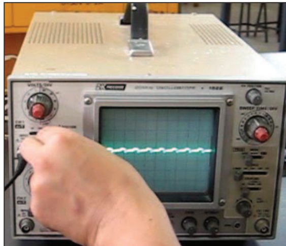
Figura 4-49: Onda irregular observada en el osciloscopio
