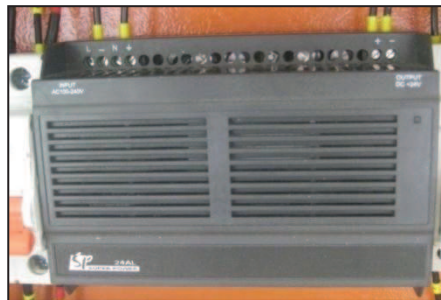
Figura 5-24: Fuente del PLC 220v a 24v
