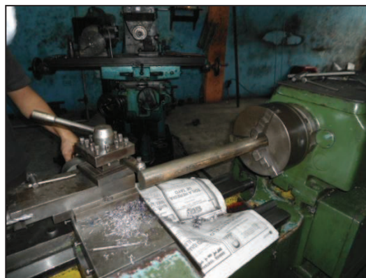
Figura 5-5: Construcción de los ejes
