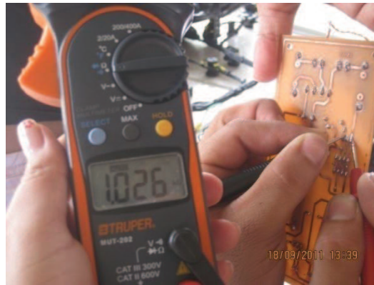
Figura 6-4: Resistencia del potenciómetro ajustada a 1K\Omega
