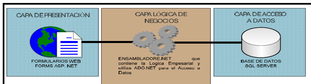
Figura 2.11: Capas de la Aplicación Web
