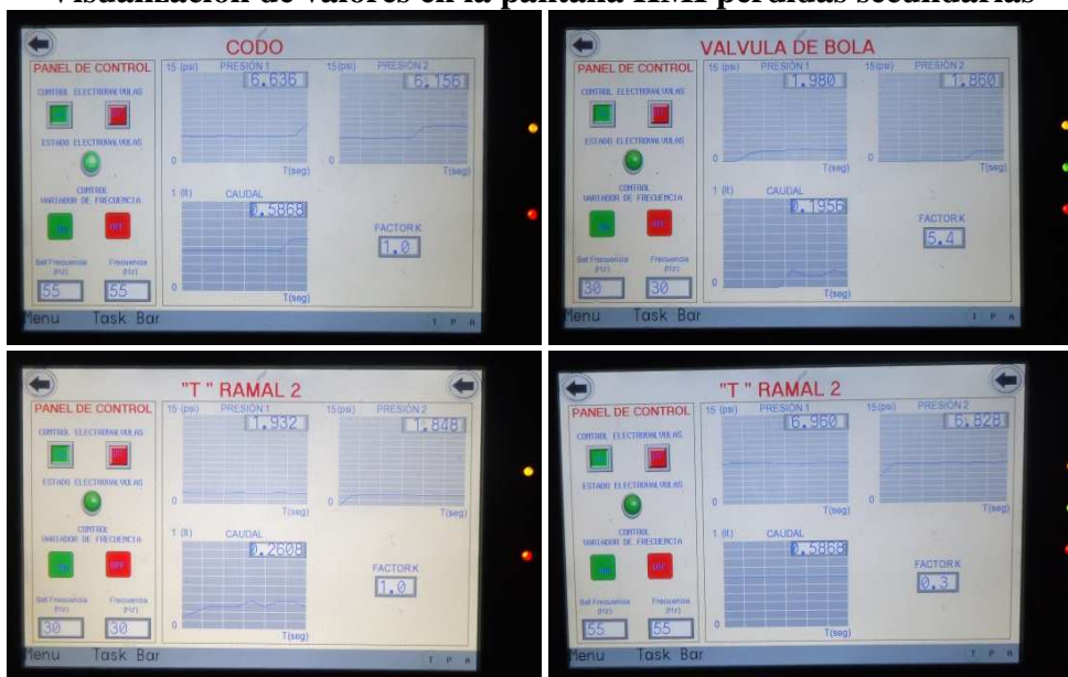
Figura. 4.16 Visualización de valores en la pantalla HMI pérdidas secundarias
