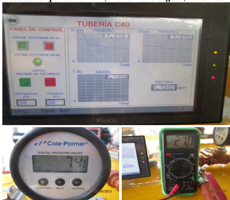
Figura. 3.11 (e) Resultados pantalla HMI, manómetro digital, multímetro
