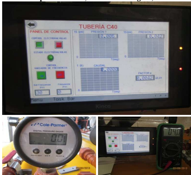
Figura. 3.11 (a) Resultados pantalla HMI, Manómetro Digital, Multímetro
