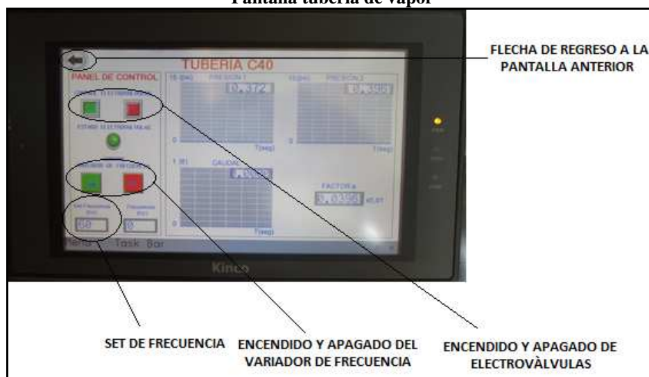
Figura. A.8 Pantalla tubería de vapor
