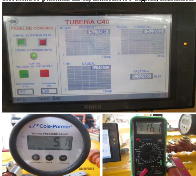
Figura. 3.11 (d) Resultados pantalla HMI, manómetro digital, multímetro
