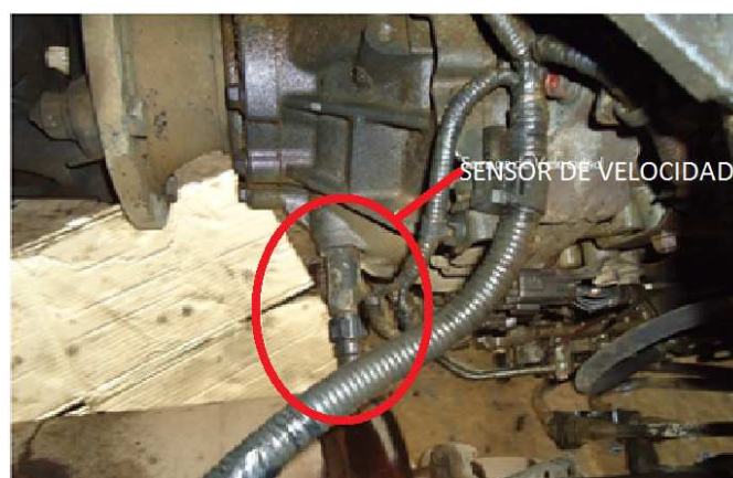
Figura 5.2 (b) Ubicación del sensor de velocidad
