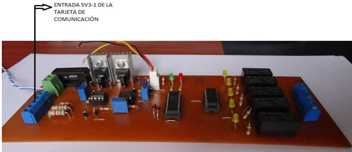
Fig. 9. Ubicación del pin de entrada del interruptor de "presión de aceite de caja de cambios" en la tarjeta
