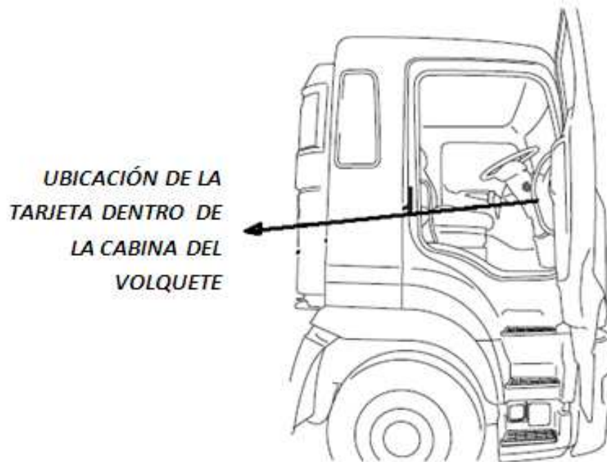
Fig. 1. Ubicación del gabinete de fusibles (vista panorámica) FUENTE: Talleres del GADPSDT
