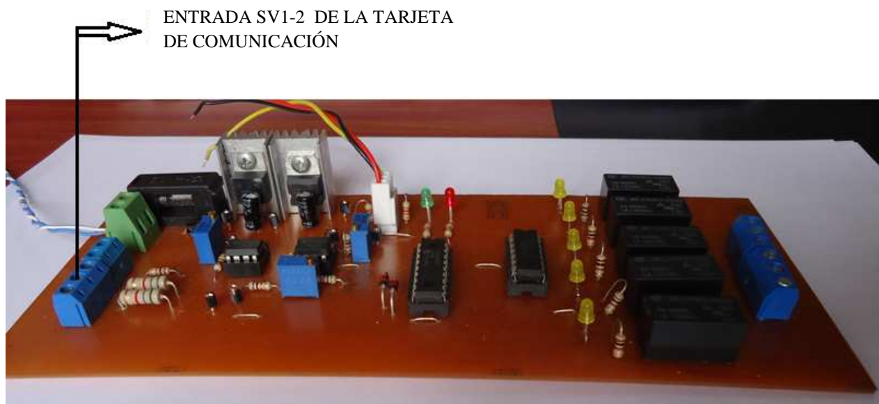
Fig. 15. Ubicación del pin de entrada de presión de aceite de motor en la tarjeta FUENTE: Talleres del GADPSDT
