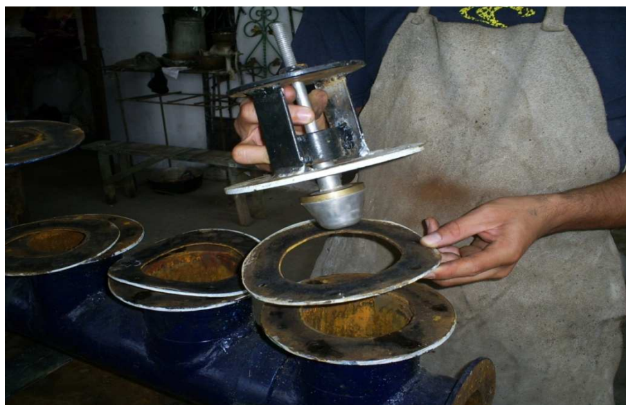
Foto N° 9. ENSAMBLE DE LAS BRIDAS Y EMPAQUES.
