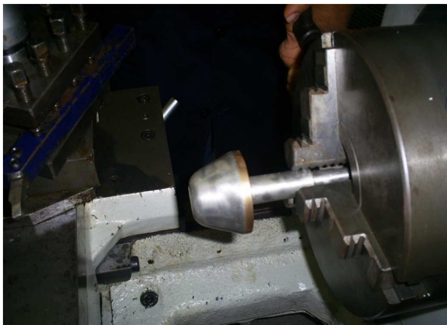
Foto N°8. VÁLVULA DE IMPULSIÓN TERMINADA.
