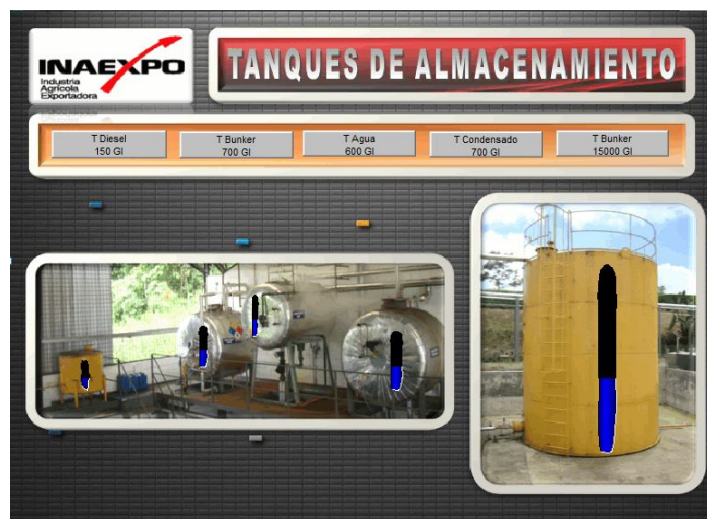
Figura 4.35 Pantalla Tanques de Almacenamiento
