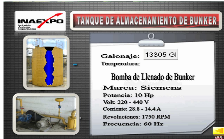
Figura 4.40 Pantalla Tanque de Bunker 15000 GI
