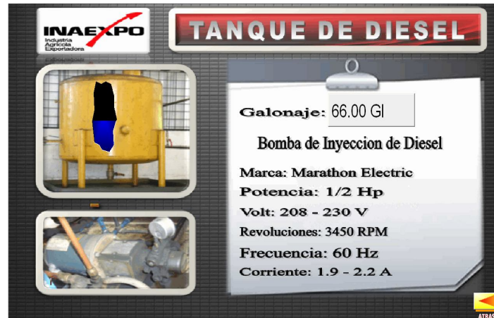
Figura 4.36 Pantalla Tanque de Diesel 150 Gl
