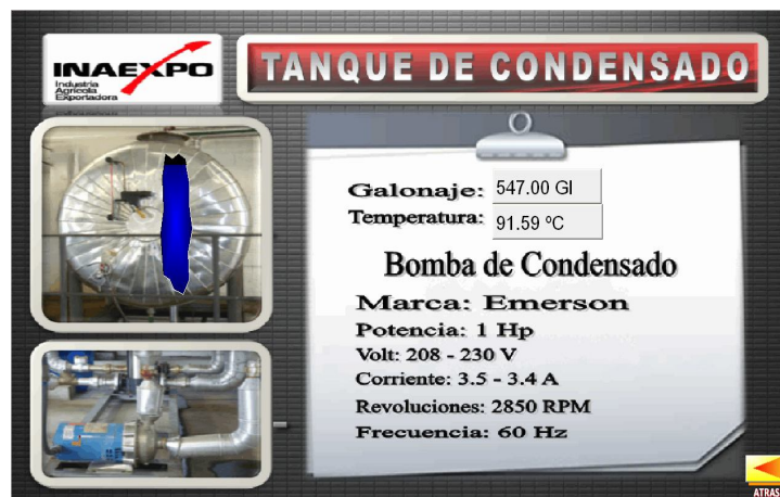
Figura 4.39 Pantalla Tanque de Condensado 700 Gl
