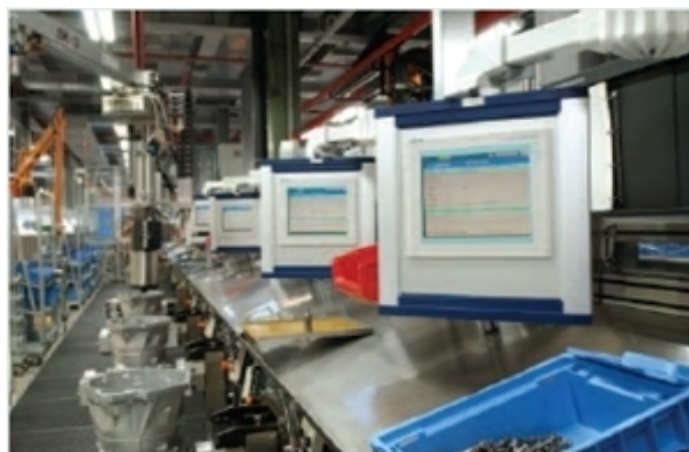
fig. 3 Paneles HMI en cascada (Proceso Industrial)
