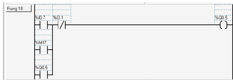
fig. 1067. Control individual de las Bobinas
