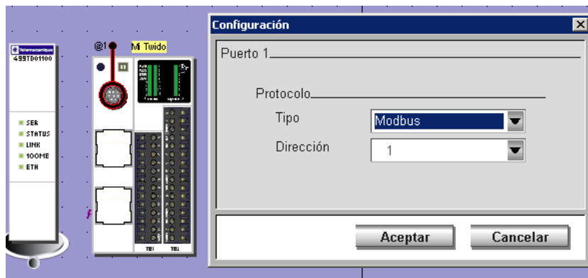
fig. 343. Configuración puerto Minidin (RS - 485)
