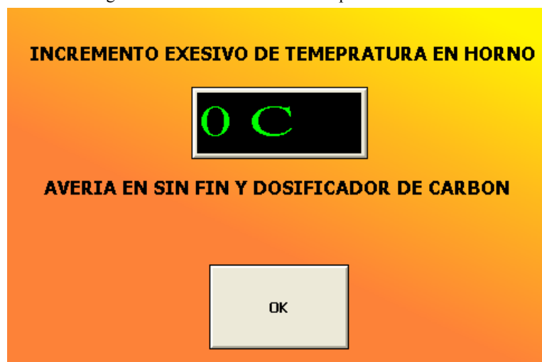
fig. 640. Ventana de alarma Temperatura Horno.
