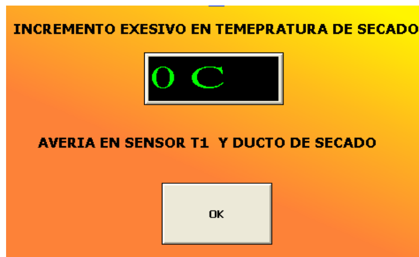
fig. 696. Ventana de alarma Temperatura Horno.
