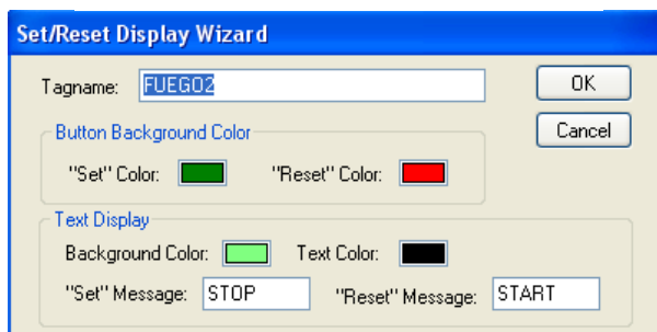
fig. 873. Configuración Set Reset Display
