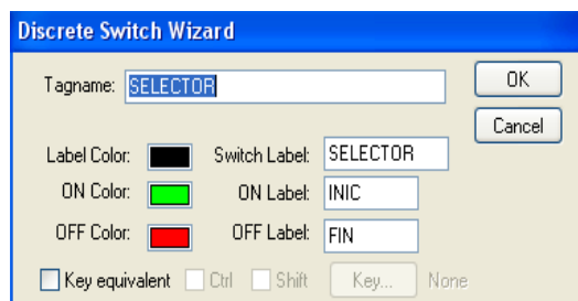
fig. 672. Configuración Discrete Switch Wizard
