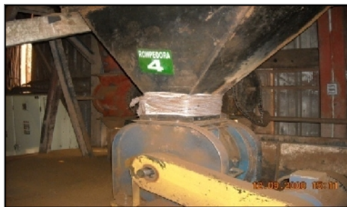
Fig. 1.6 Ripell Mill (Rompedoras de nuez SIEXPAL S.A.)
