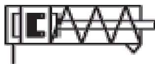
FIGURA 3.7 Mecanismo interno del cilindro seleccionado.
