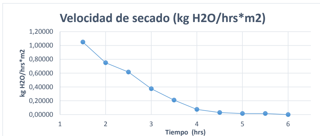
Figura 9: Velocidad de secado de RSD en secador de bandejas a nivel de laboratorio.
