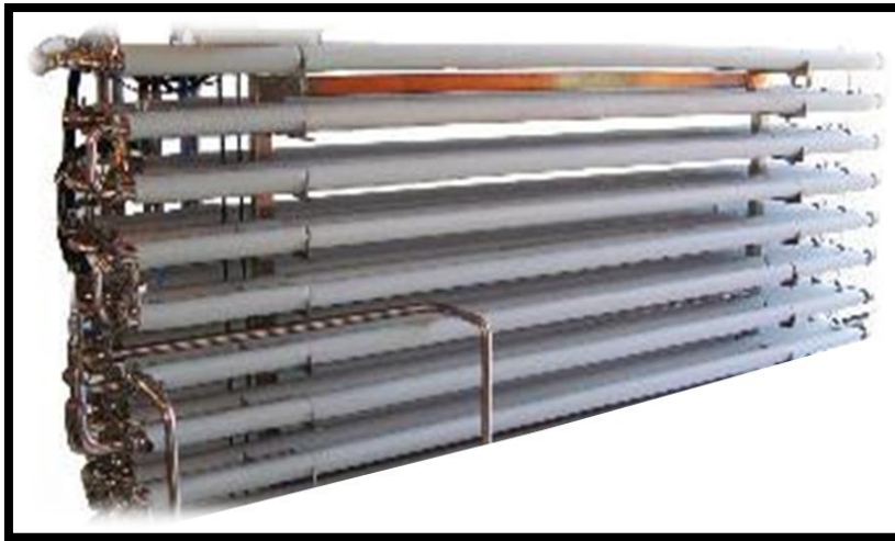
Figura 28: Bloque de tubos de vapor.
