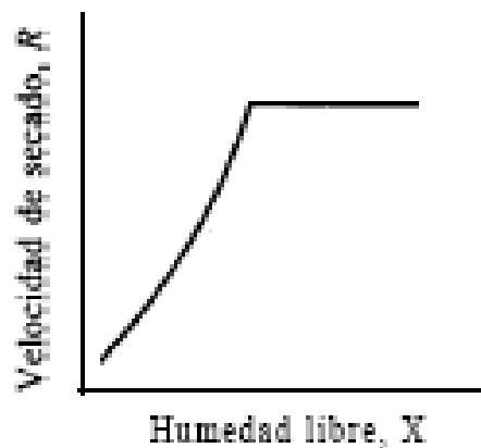
Figura 3. Velocidad decreciente de Secado, controlada por Difusión (Geankoplis, 1998)
