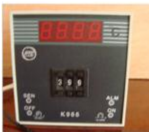
Figura 6. Medidor de temperatura
