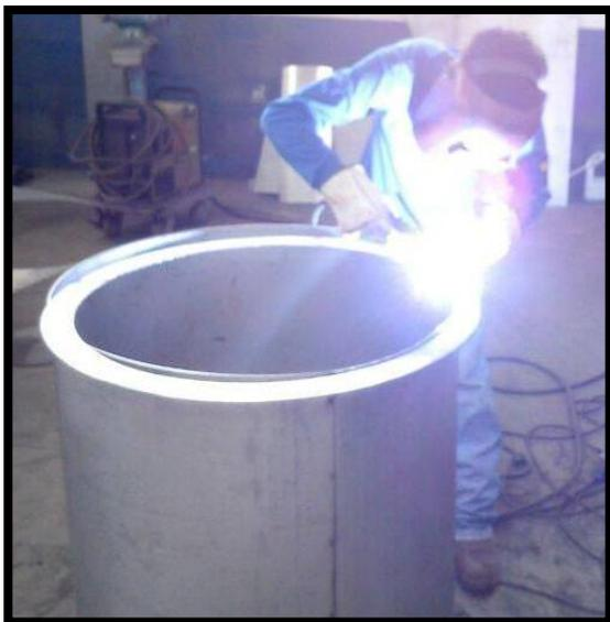
**Construcción del pasteurizador**
