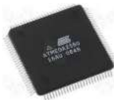
Figura 17. Microcontrolador ATmega2560 (Nerokas, 2017)
