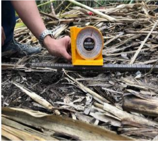
Medición de pendiente en el terreno
