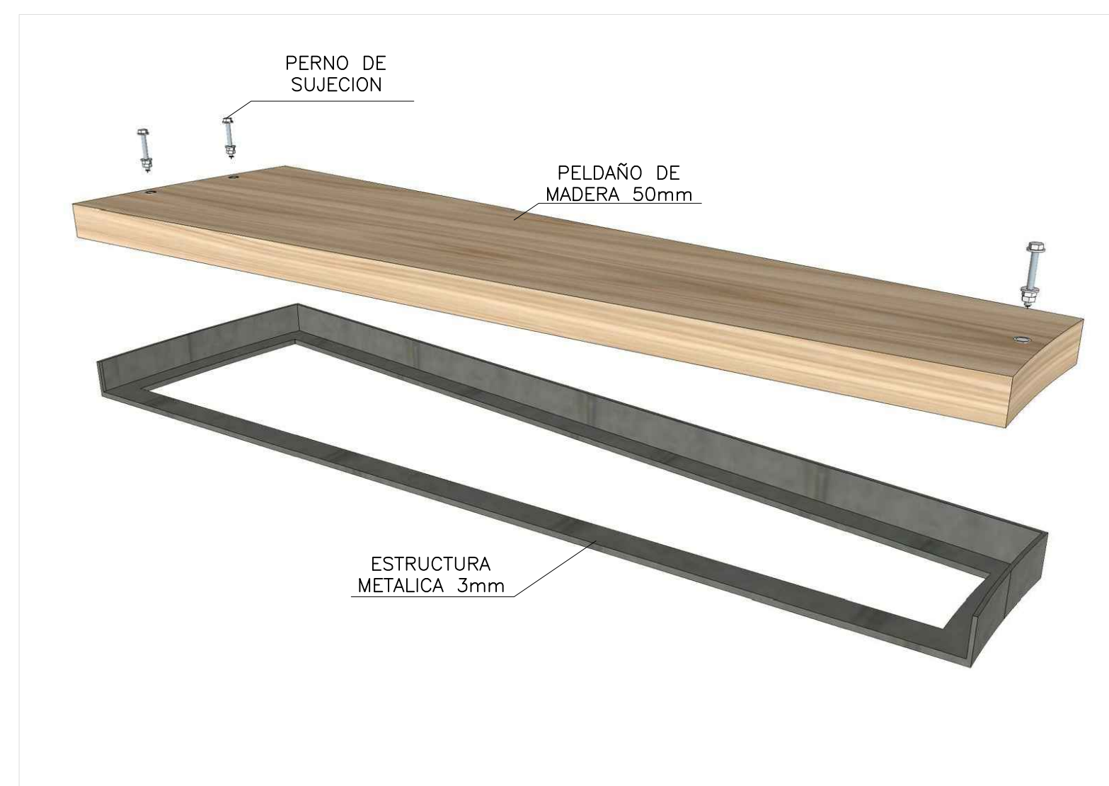
DETALLE - ANCLAJE DE HUELLA ESCALA.....S/E
