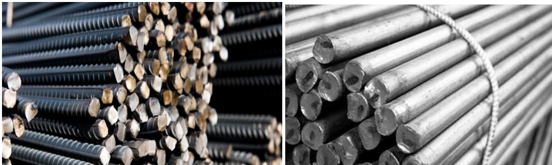
Ilustración 30 Acero liso y corrugado
