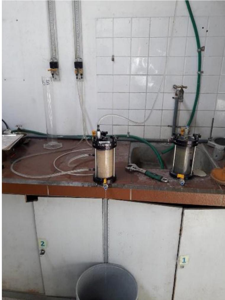
Permeámetro de Carga Constante del Laboratorio de Suelos de la carrera de Ingeniería Civil, Pontificia Universidad Católica del Ecuador. El permeámetro está regulado con la norma ASTM D-2434.
