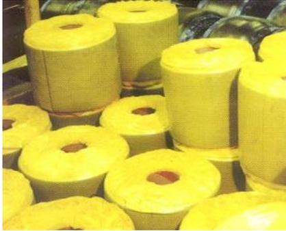
El hule cojín es un adhesivo a base de caucho natural, resinas fenólicas derivadas del petróleo, negro de humo y aceites de proceso, recubierto por una cara con una película de polietileno pigmentado como protección, tiene una presentación en verde (sin vulcanizar).
