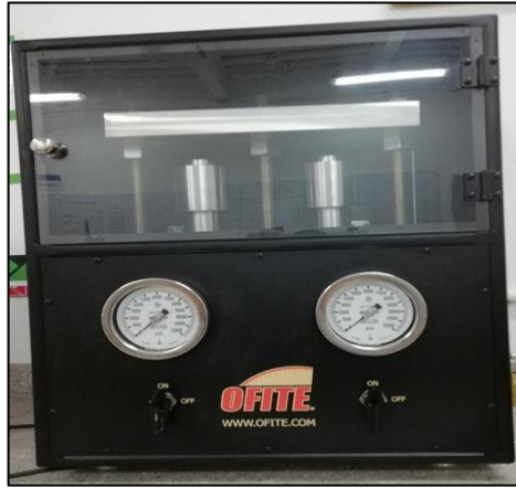
Figura 8. Máquina de compactación para pastillas de bentonita
