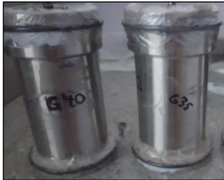
Figura 9. Cápsulas para prueba de rolado.
