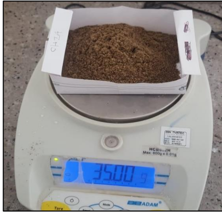
Figura 18. Balanza y concentración de semilla de chía ( Salvia hispanica L.) pesada para fluido F2
