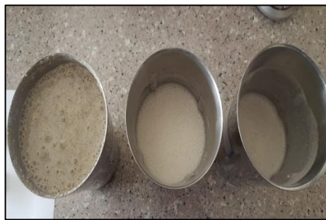
Figura 19. Fluidos listos para prueba de hinchamiento lineal
