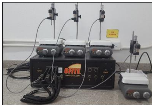
Figura 7. Equipo de hinchamiento lineal
