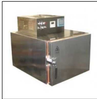
Figura 6. Horno para prueba de rolado
