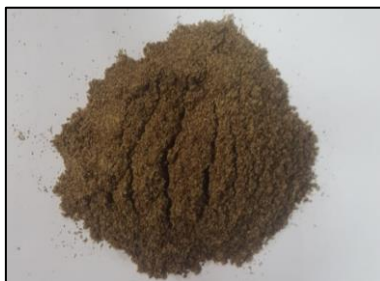
Figura 11. Lote 2. Chía tamizada malla 200.
