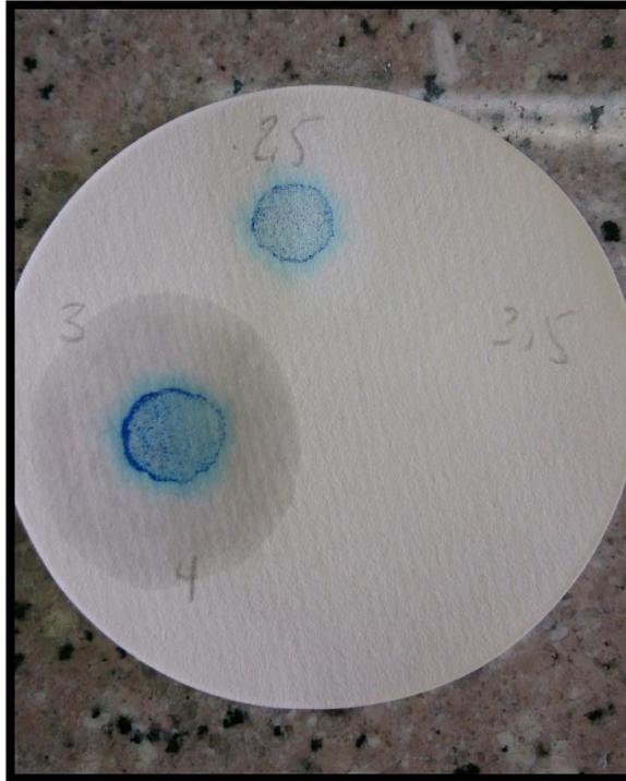
**Figura 6.** Fotografía del Halo formado a una concentración de 2.5 ml de azul de metileno
