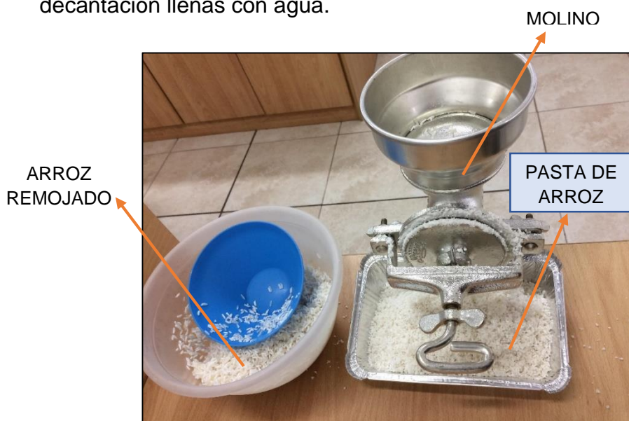
Figura 4. Fotografía molino manual utilizado en el triturado
