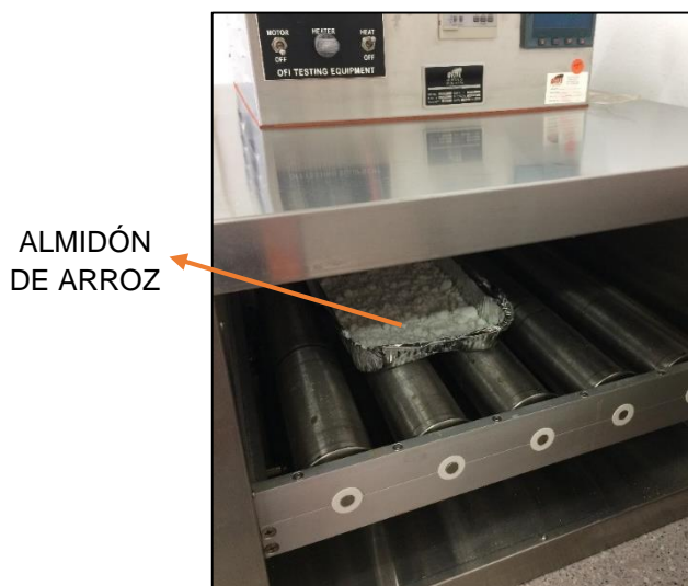
Figura 6. Fotografía horno de rolado OFITE modelo 173-00-RC
