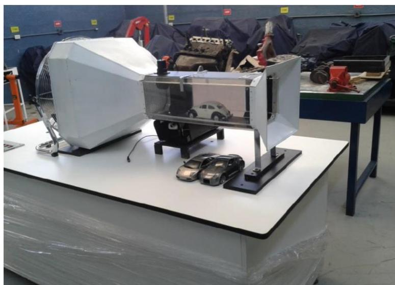
**Figura 1.** Túnel de Viento abierto.
