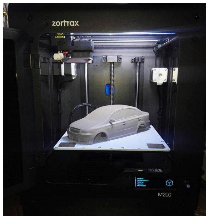
**Figura 4.** Impresión 3D prototipo AVEO.
