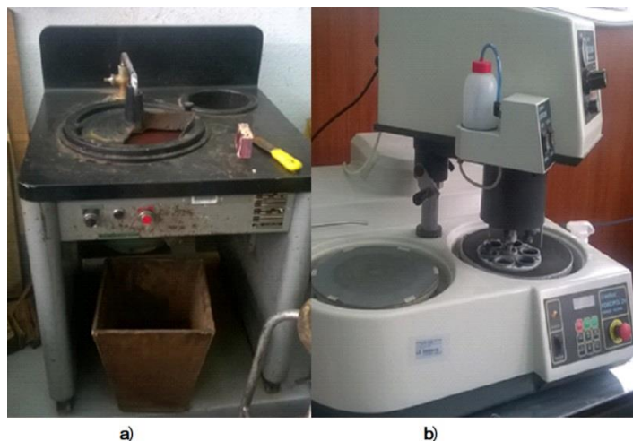
Figura 31. (a). Desbaste grueso, (b) Desbaste fino
