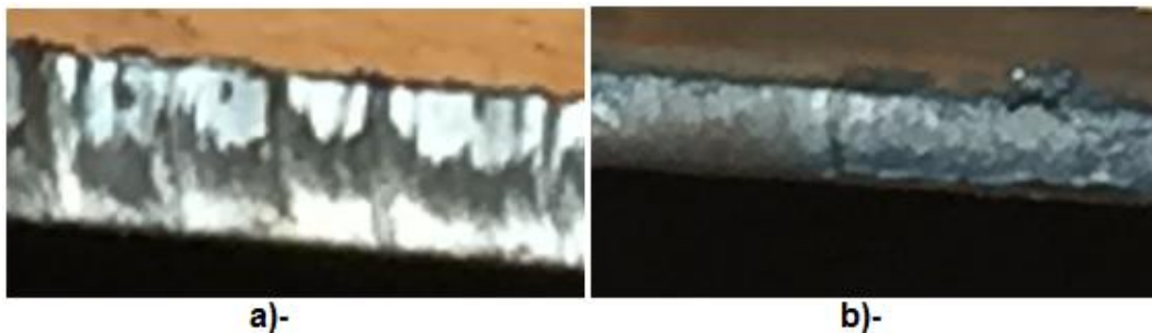
Figura 23. Acero A108, a) corte por plasma, b) corte oxiacetilénico.
