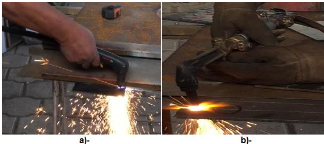
Figura 15. Corte de las muestras, a) plasma, b) oxicorte
