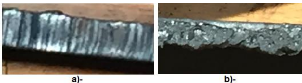
Figura 25. Acero A131, a) corte por plasma, b) corte oxiacetilénico.
