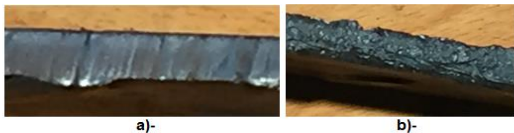
Figura 24. Acero A36 - ST37.2, a) corte por plasma, b) corte oxiacetilénico.
