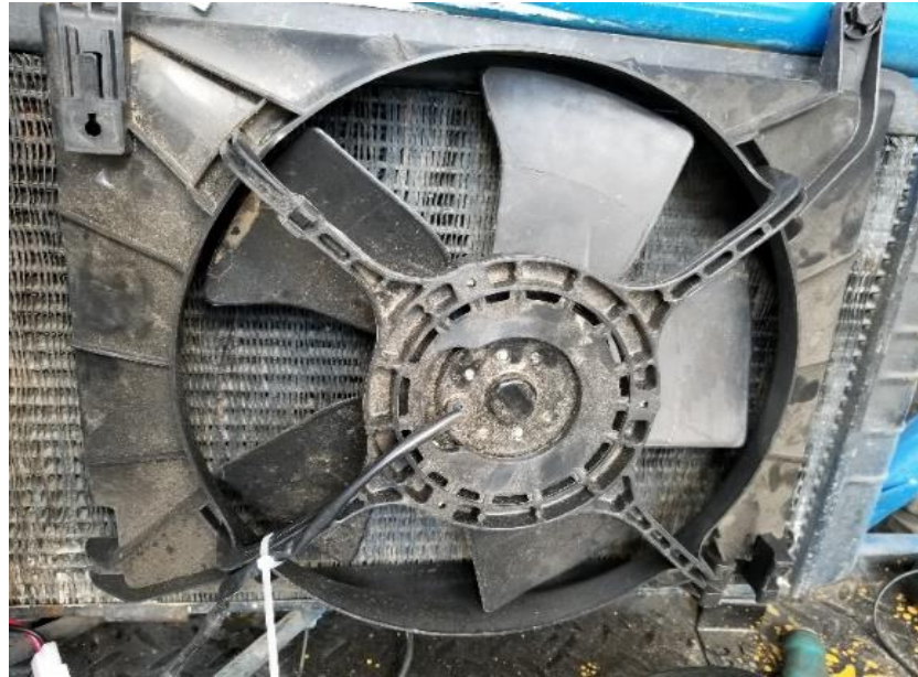
Figura 29. Sistema de ventilación para el radiador
