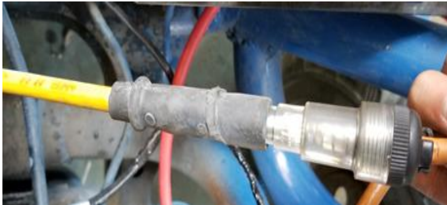
Figura 35. Utilización del tester comprobador de cables de bujías
