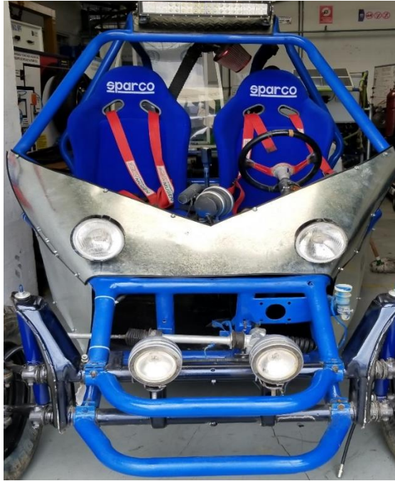
Figura 27. Sistema de iluminación delantera
