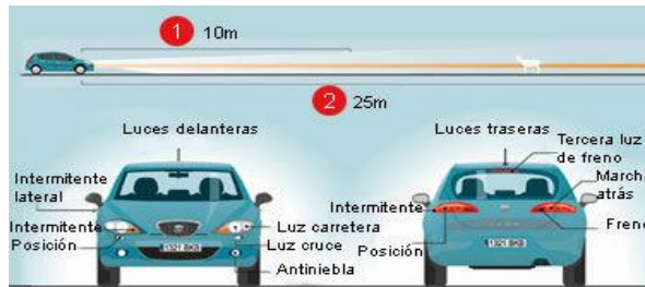
Figura 4. Elementos del sistema de iluminación (EROSKI, 2017)
