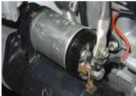
Figura 25. Instalación del sistema de arranque
