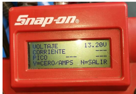
Figura 26. Prueba de voltaje del sistema de carga
