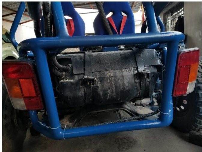
Figura 28. Sistema de iluminación posterior
