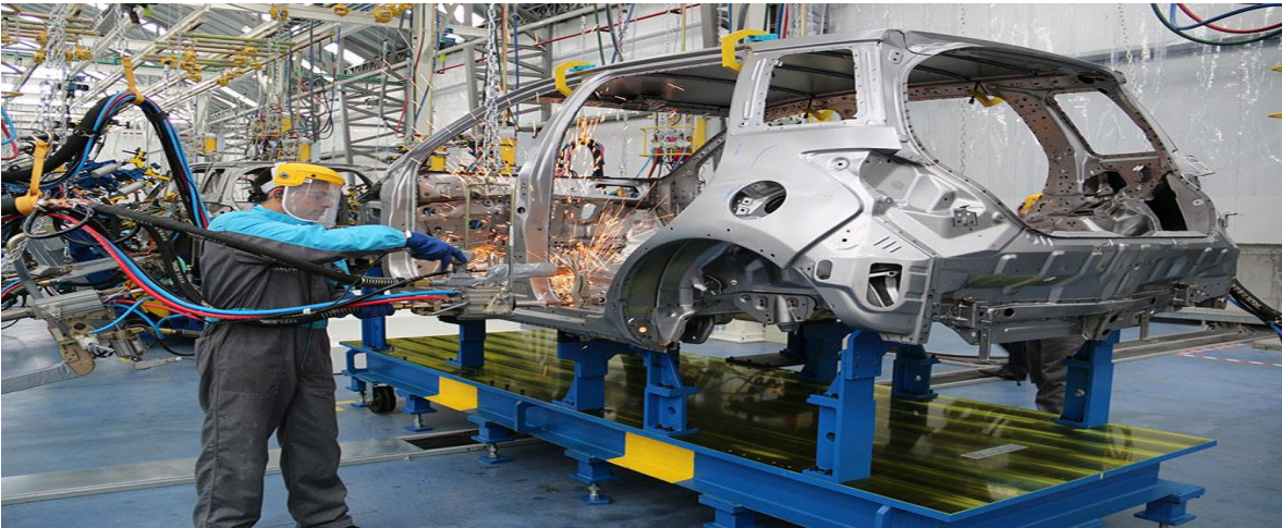
Figura 1.11: Etapa de doblado y soldado de la carrocería.
