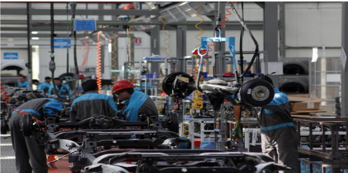
Figura 1.12: Instalación de llantas.
