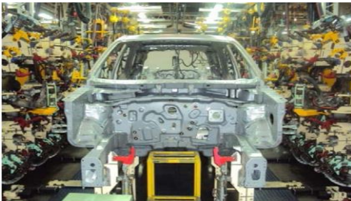
Figura 1.3 Área de soldadura.
