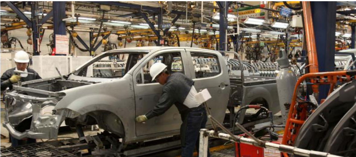
Figura 1.16: Desmonte de puertas.
