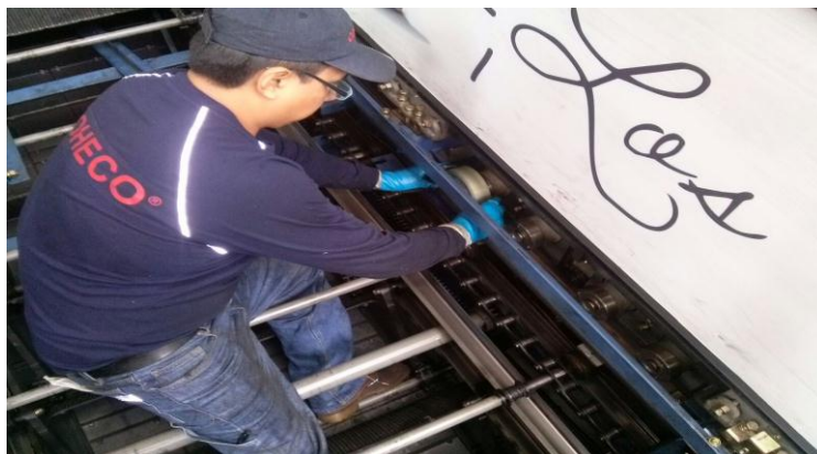
Figura 69. Mantenimiento del conjunto de arrastre. Elaborado por: el autor (2015)
