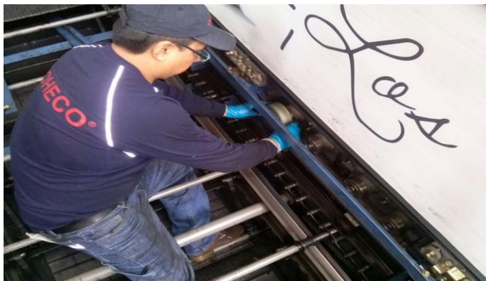
Figura 57. Mantenimiento del conjunto de arrastre. Elaborado por: el autor (2015)
