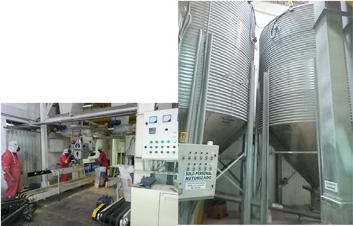
Figura 4: Trabajadores del área de envasado expuestos al ruido y silos pulmón de maíz y de soya
