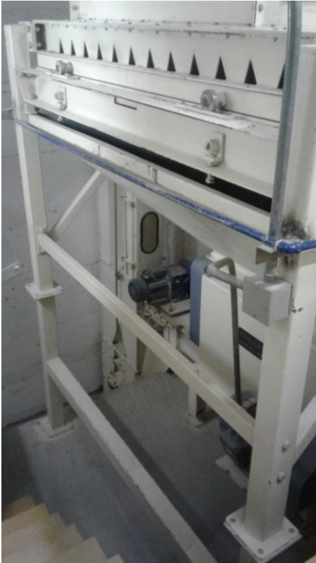
Figura 15: Compartimiento bajo nivel donde funciona el enfriador de pelets
