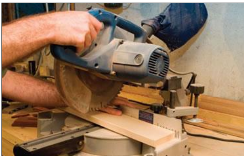
Figura 11. Riesgo de atrapamiento en equipo cortador de madera
