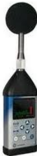
FIGURA No. 7 Sonómetro utilizado para la medición
