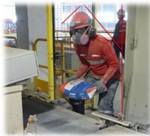
Gráfico 5. 12 En esta actividad se incluye las tareas de levantamiento de cargas manual por saco, traslado y apilamiento en el piso de la carga generando múltiples movimientos que fueron evaluados por grupo muscular en el capítulo anterior
