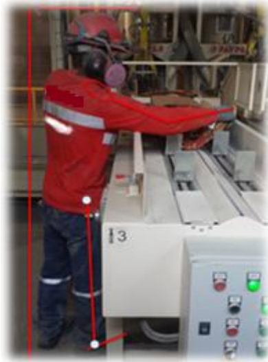
Gráfico 5. 11 Alimentación de la máquina ensacadora con fundas vacías y operación de la máquina para procesos de sellado y relleno automático de material
