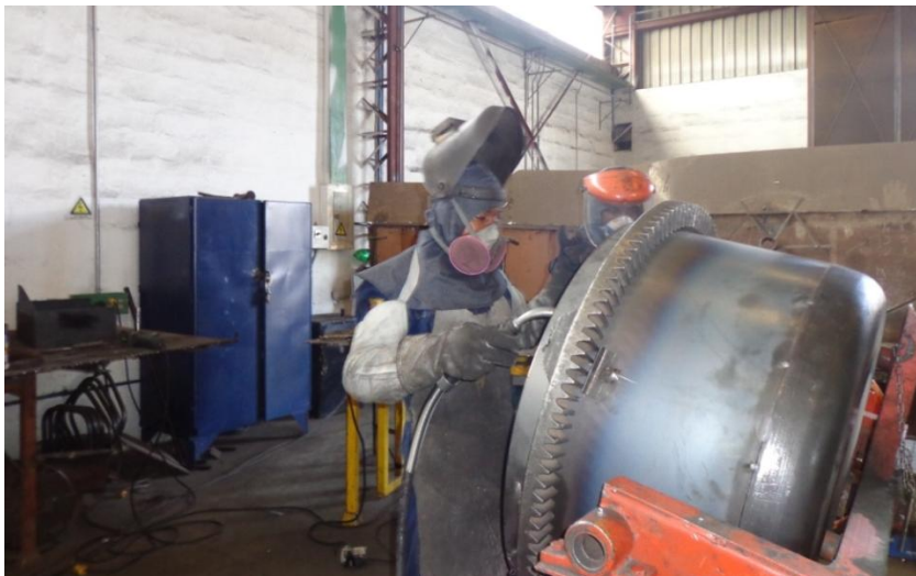
Fotografía 4.7: Unión de piezas metálicas por medio de soldadura MAG Lugar: Empresa metalmecánica Año: 2015
