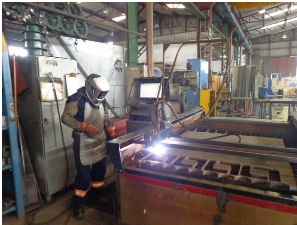
Fotografía 4.5: Corte de plancha metálica con plasma
