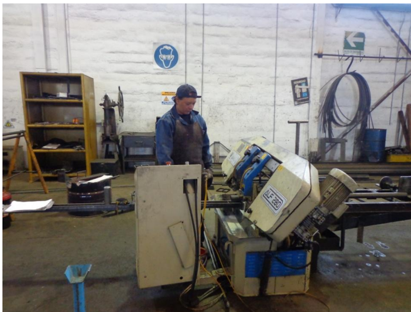
Fotografía 4.6: Corte de perfiles metálicos con sierra cinta Lugar: Empresa metalmecánica Año: 2015
