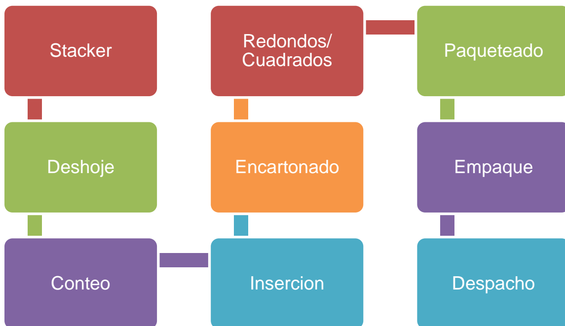
Gráfico 12: Secuencia del proceso del personal del área de postprensa Fuente: Proceso del área de producción postprensa GEC, 2014. Elaborado por: Paola Floril
