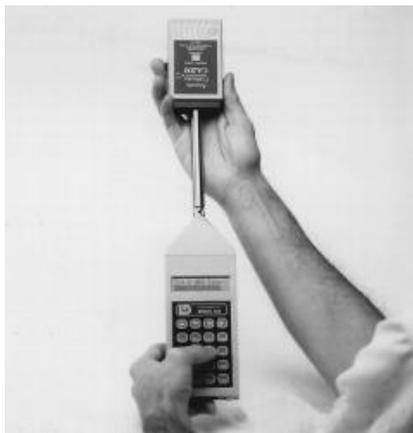
**Figura 3:** Sonómetro. Control de calibración
