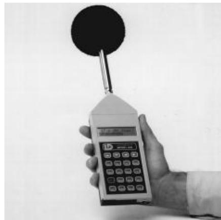
**Figura 4:** Sonómetro con guardavientos
