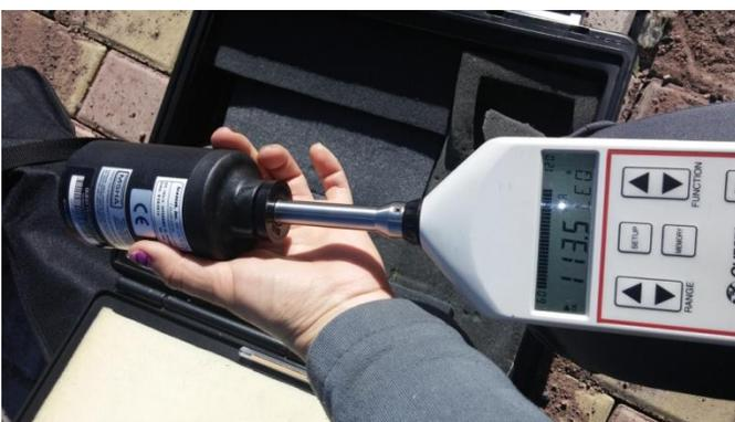
**Figura 11: Calibración-Verificación**
